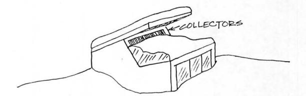
FIGURE 21. SNOW OBSTRUCTING COLLECTORS
