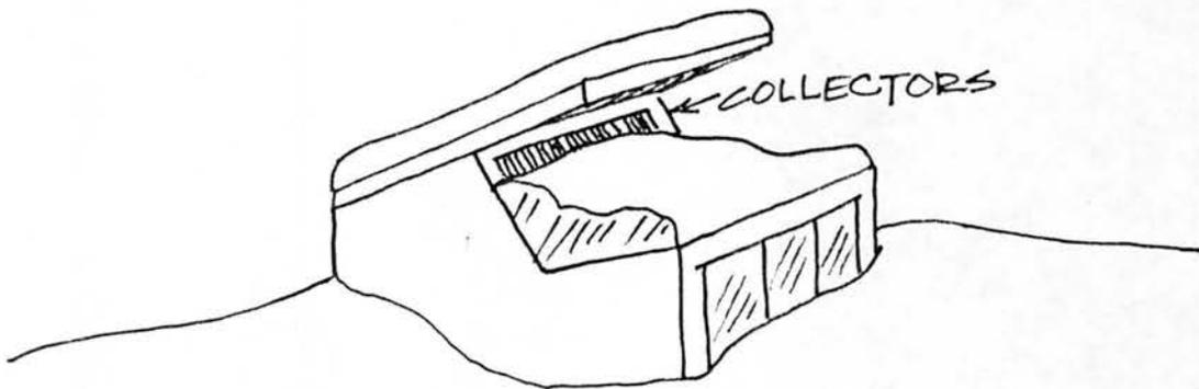
FIGURE 21. SNOW OBSTRUCTING COLLECTORS
