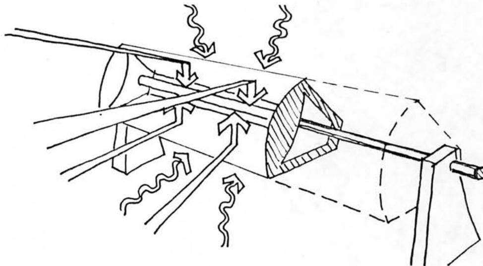
FIGURE 5. MOST CONCENTRATING COLLECTORS USE ONLY DIRECT RADIATION
