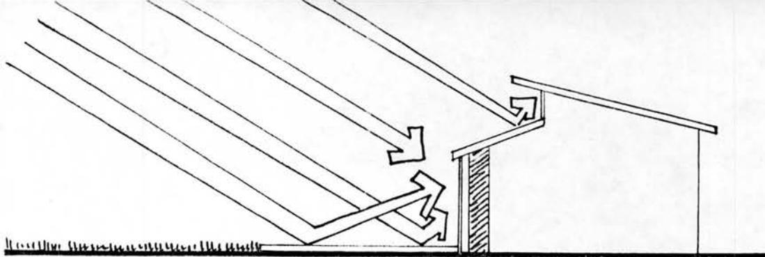
FIGURE 10. LIGHT SURFACES INCREASE RADIATION
