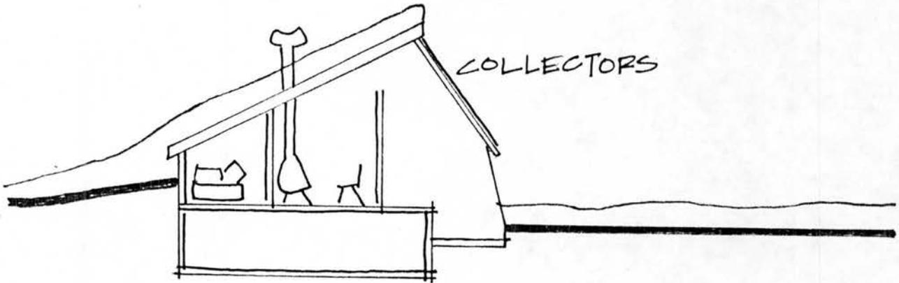
FIGURE 20. THE OUROBOROS HOUSE USES SNOW FOR INSULATION
